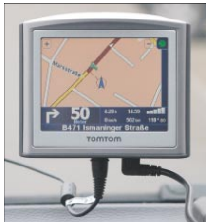
Rechts unten führt das Ladekabel zum Zigarettenzünder. Das Kabel links ist vom TMC-Empfänger, dessen Elektronik in dem ovalen Ei sitzt.
