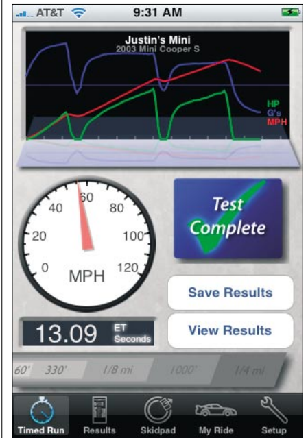
Die Beschleunigungssensoren des iPhones werden vom Programm Dynolicious für Geschwindigkeitsmessungen genutzt - auch die Navi-Programmierer könnten sie sich zu Nutze machen
