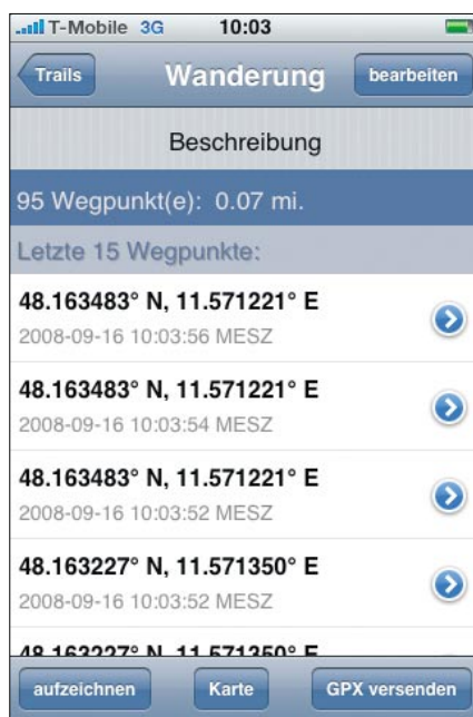
Das Tracklogger-Programm Trails speichert alle zwei Sekunden die Position ab - auch wenn das iPhone in den Standby-Betrieb wechselt
