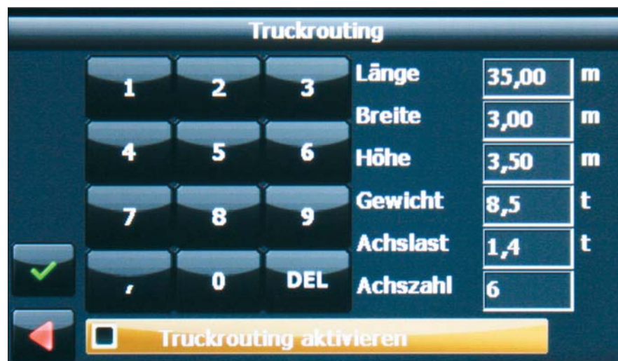
LKW-Navis ermöglichen die Eingabe der spezifischen Fahrzeugdaten
